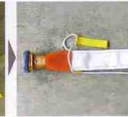
⑧差し込み継ぎ手に結束ベルトを通す事により紛失を防ぎます
