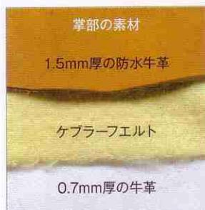
ロープがあたる掌部の補強は1.5mm厚の防水牛革を使用。さらに断熱材としてケブラーフエルトを中間層に入れて、摩擦熱から手を保護します。
