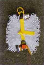
①表側ホースを正方形に折りたたむ。金具ごと結束する。取っ手が動くので結束後、適正な位置に修正できる。
